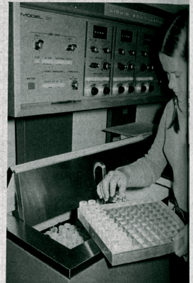
In diesem Szintillationspektrometer wird die Radioaktivität von Proben nach in vitro-Proteinsynthese gemessen, nachdem radioaktive Aminosäuren in das Protein eingebaut wurden. Die Resultate geben quantitativ Auskunft über die Wirkung verschiedener regulierender Proteinfaktoren auf den Prozeß der Proteinsynthese. Die Fragen der spezifischen Regulation der Proteinsynthese auf der Ebene der Translation sind bis heute unbeantwortet. Sie können nur experimentell geklärt werden, wenn man definierte zellfreie Systeme schafft für die Translation von isolierter Boten-Ribonukleinsäure, die identifizierbare Proteine kodiert. Der Mechanismus der Initiation der Polypeptid-Ketten-Synthese ist offensichtlich der wichtigste Schritt der Translation, wo eine Regulierung einsetzen kann.
