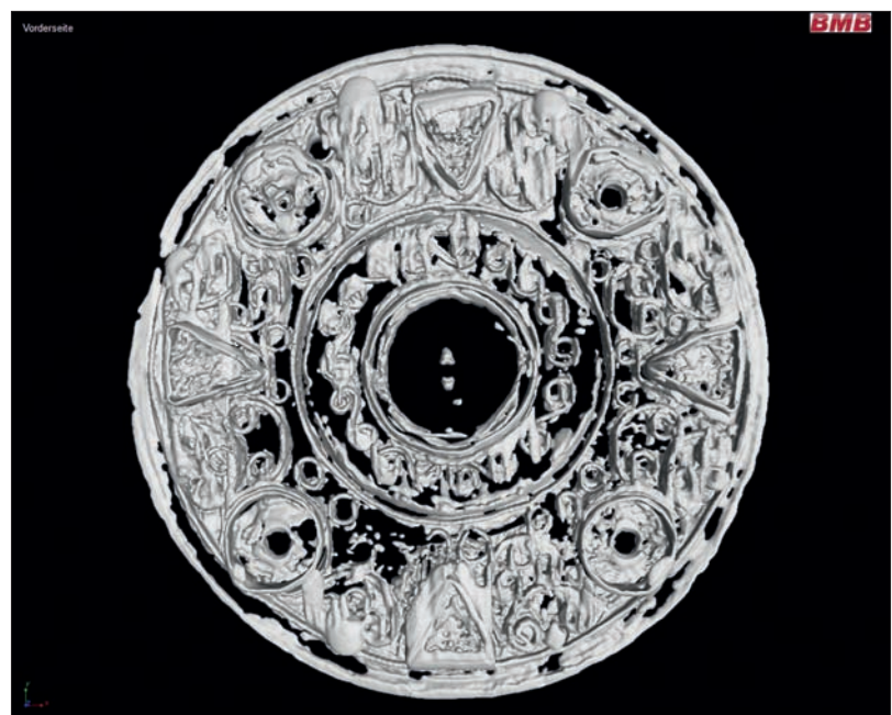
Abb. 1 Computertomographie der goldenen Filigran- scheibenfibel von Heil- bronn, Friedensplatz, Grab 4 Vorderansicht Untersuchung und Bild: BMB, Gesellschaft für Materialprüfung mbH in Heilbronn, 2017
